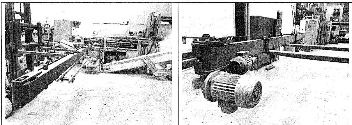
Figura 48 – Nastro trasportatore con motore TLS S.r.l.
