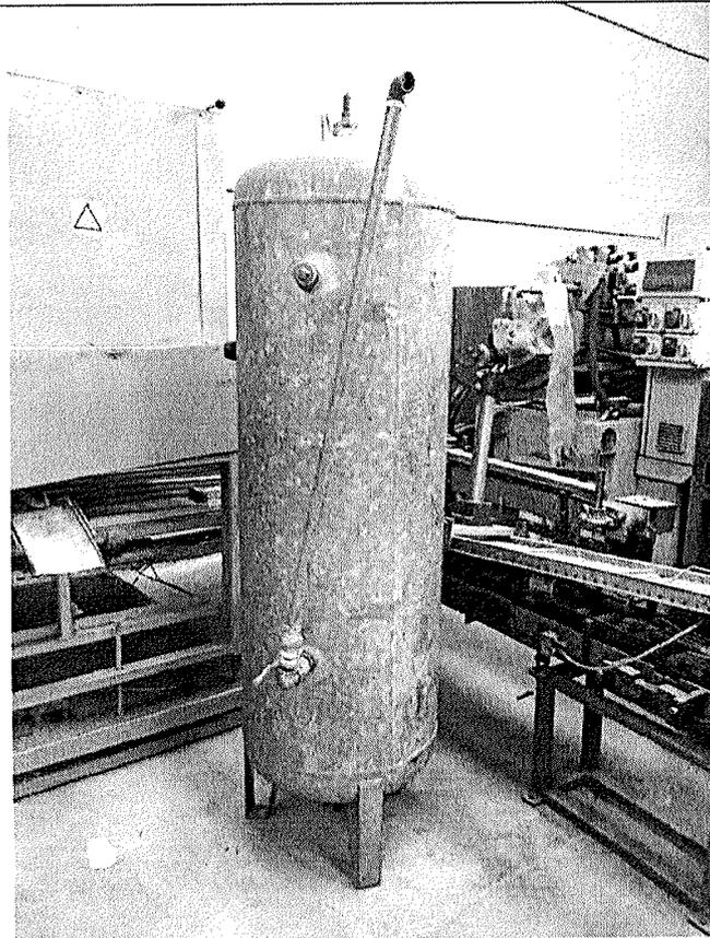
Figura 18 – Serbatoio verticale n. 2 in acciaio per aria in pressione marca SiCC
