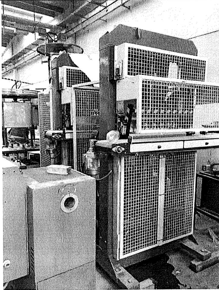
Figura 24 – Macchina n. 2 per la produzione di lumini e ceroni dotati di n. 6 stampi
