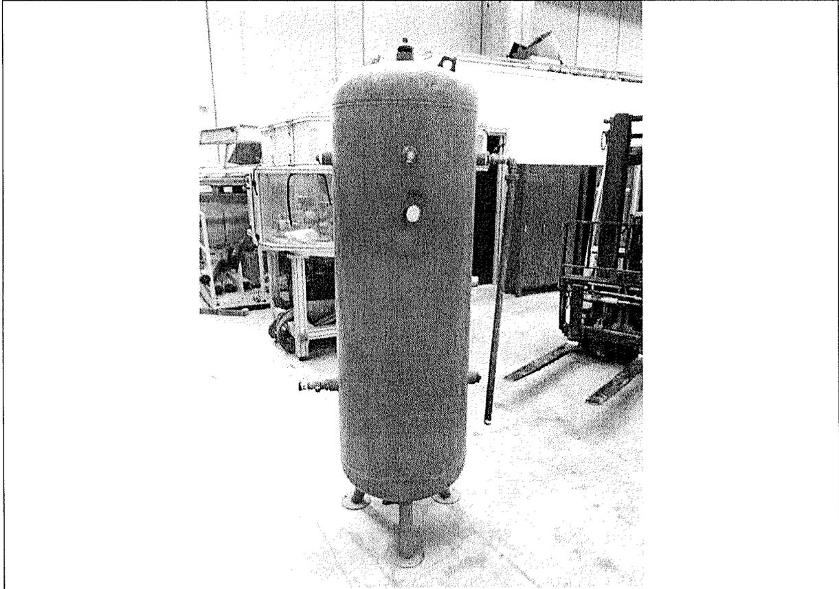
Figura 17 – Serbatoio verticale n. 1 in acciaio per aria in pressione marca SiCC
