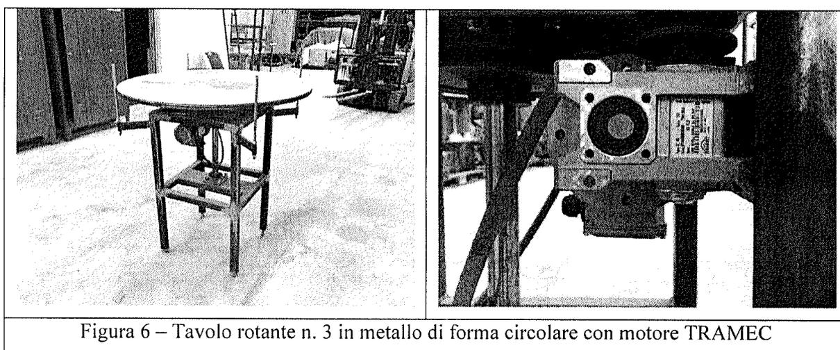
Figura 6 – Tavolo rotante n. 3 in metallo di forma circolare con motore TRAMEC
