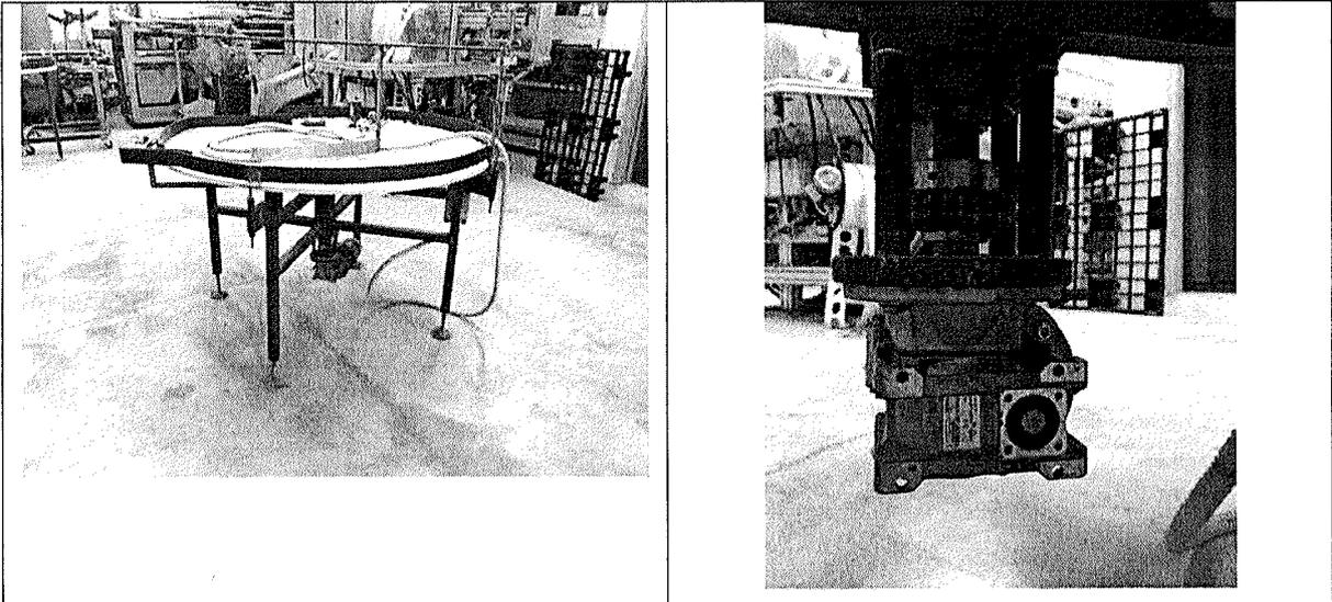
Figura 7 – Tavolo rotante n. 4 in metallo di forma circolare con motore TRAMEC
