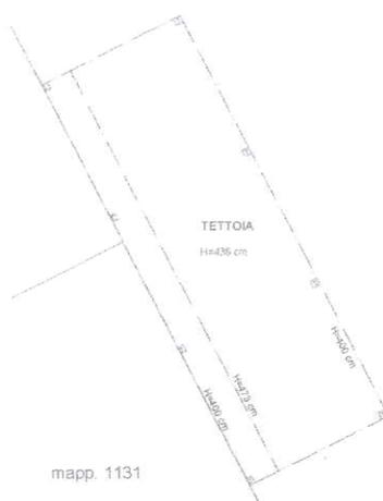
La tettoia è posta lungo il confine ovest del mapp. 1562, ha una superficie di mq. 124 ca. ed è stata realizzata alla fine degli anni '90 con colonne e capriate reticolari in acciaio, copertura in lamiera grecata zincata e pavimentazione in calcestruzzo liscio.
