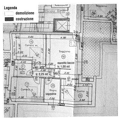
Stato di confronto tra lo stato assentito e lo stato rilevato con indicazione delle porzioni demolite (in colore giallo) e delle porzioni edificate (in colore rosso)
