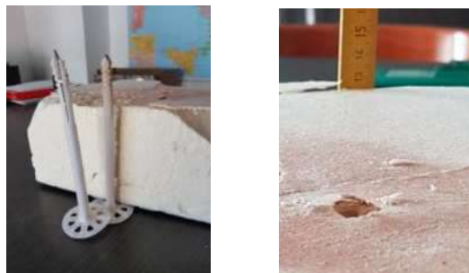
Fig. 08 fotografia tasselli e spessore del pannello
