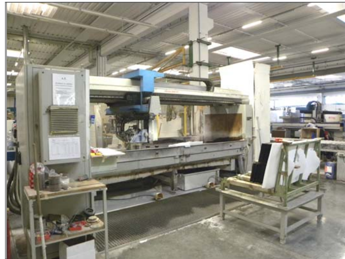
34) lavorazione CN: centro lavoro CN, Intermac - Master.23
