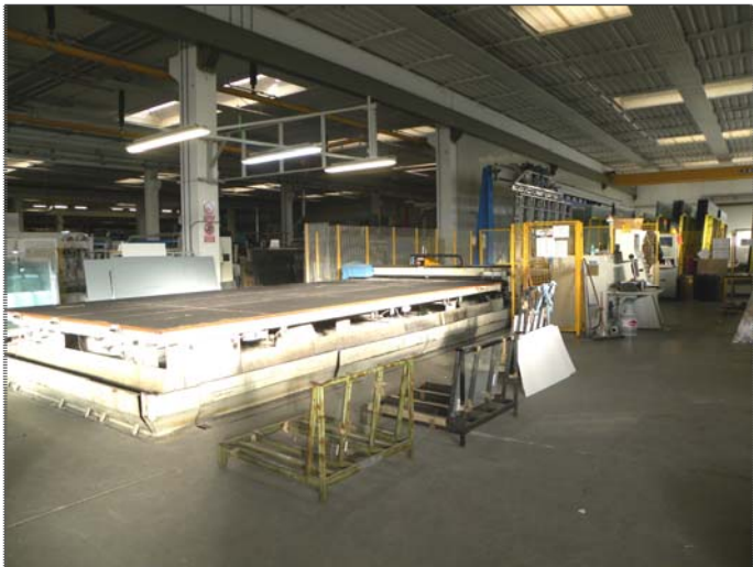
17) magazzino stoccaggio grandi lastre, RBB - 44 posizioni 19) banco taglio grandi lastre + scarico sfridi + controllo
