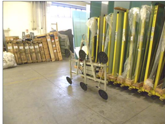
14) manipolatore a ventose, Gama - GPOL.4 16) presa a ventose, Elephant - GP6F 6 piatti
