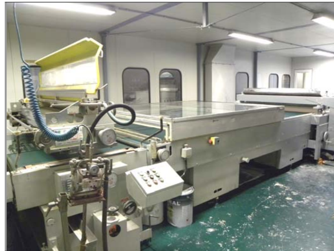
58) verniciatura a rullo/spruzzo: 2° tunnel essiccazione + raffreddamento finale 60) verniciatura a velo: sezione verniciatura a velo, Giardina
