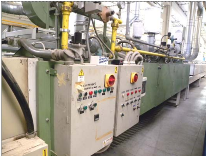
49) linea serigrafia: banco a rulli + spazzolatrice + lavasciuga 51) linea serigrafia: tunnel asciugatura
