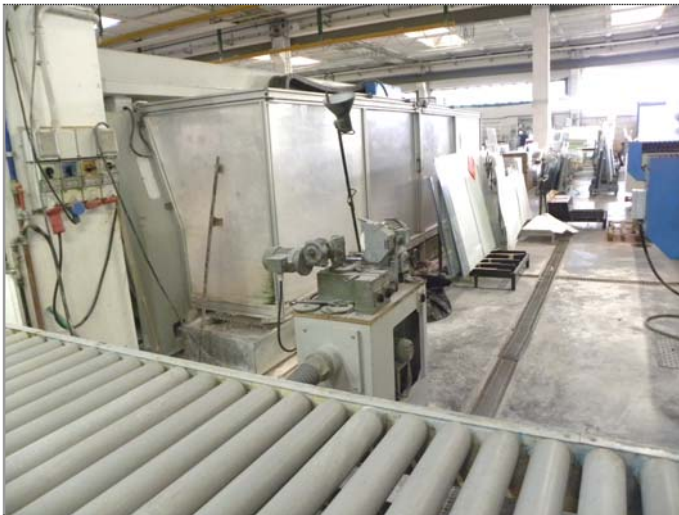
41) lavorazione CN: rulliera trasferimento + lavasciuga, Triulzi 43) ravviva mole
