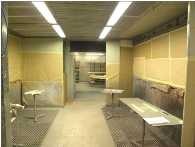
61) verniciatura a velo: tunnel essiccazione, Giardina 63) verniciatura manuale: zona spruzzatura
