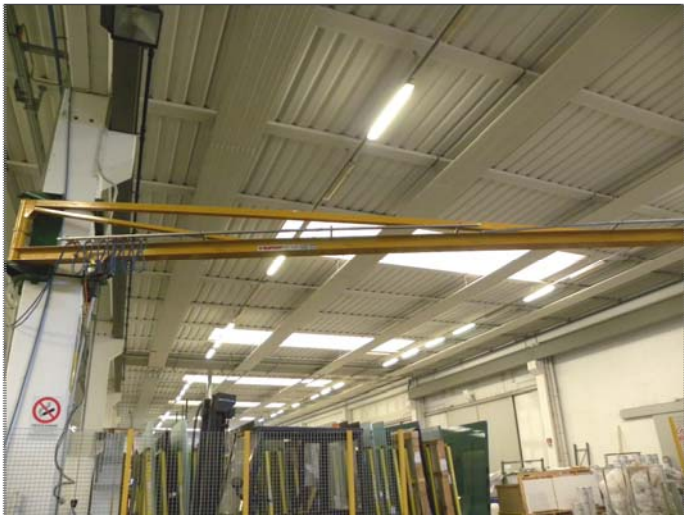
9) paranco su bandiera, Elephant - 200kg + presa a ventose 11) paranco su bandiera, Elephant - 500kg
