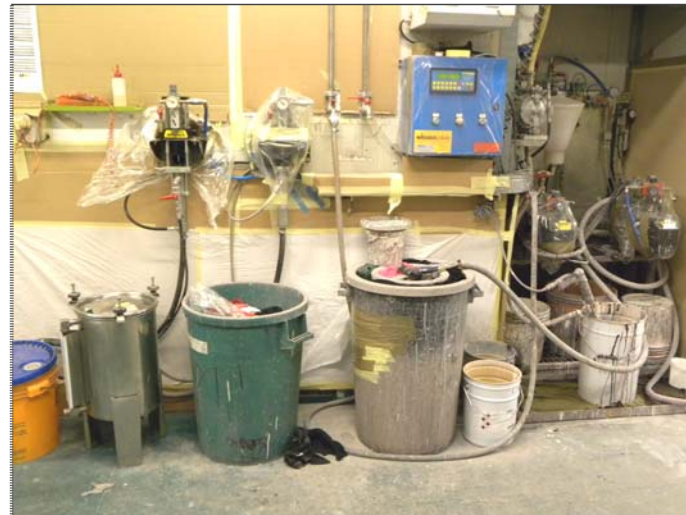
62) verniciatura a velo: 2 stazioni raffreddamento, Giardina 64) verniciatura manuale: stazione alimento vernici
