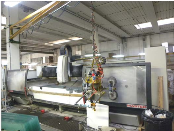
33) lavorazione CN: centro lavoro CN, Intermac - Master Edge.2300
