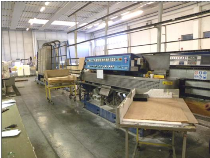
65) sabbiatura 2: sabbiatrice verticale + aspirazione/recupero polveri 67) molatrice rettilinea, Bovone
