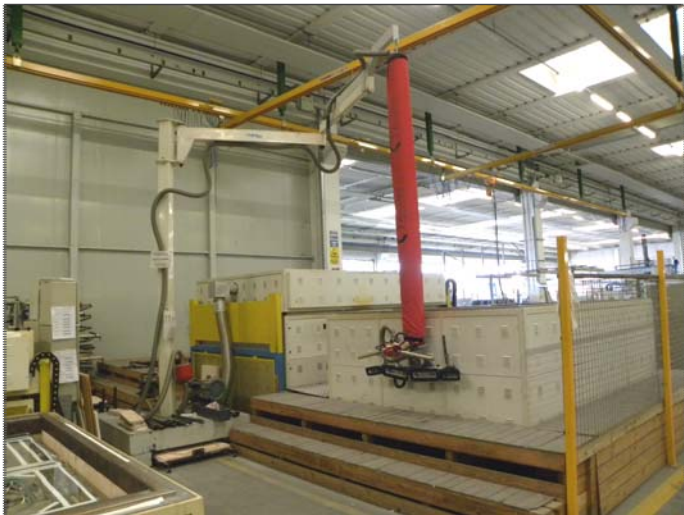
13) griffa presa mezze lastre, RBB - 2.000x3.210mm 15) sollevatore assistito, Manibo + presa a ventose, Vaculex
