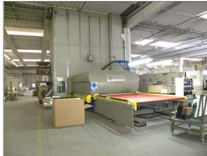
46) termoformatura: forno ricottura, Tornati - NewSystem.300 48) forno tempra, Kera Glass
