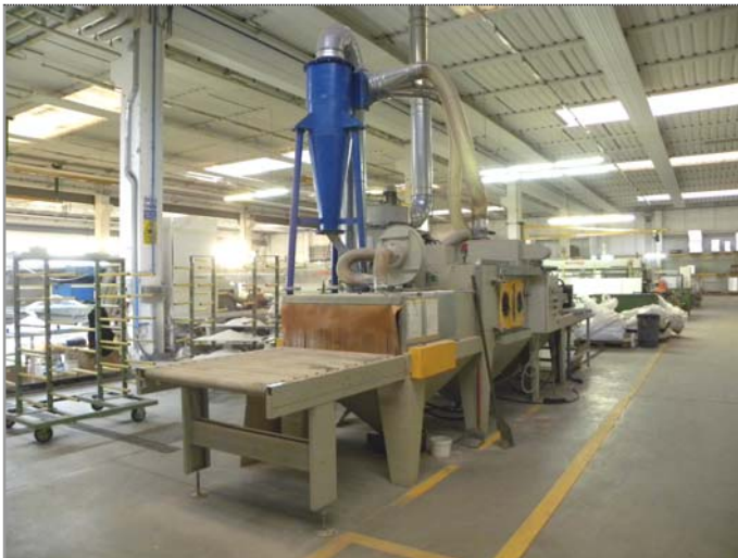
45) termoformatura : forni elettrici, Tornati - NewSystem.300 47) sabbiatura 1: sabbiatrice, Alfema + banchi/nastri + aspirazione
