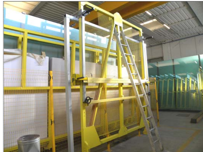
10) paranco su bandiera, Elephant - 250kg + presa a ventose 12) griffa presa grandi lastre, RBB - 3.210x6.000mm
