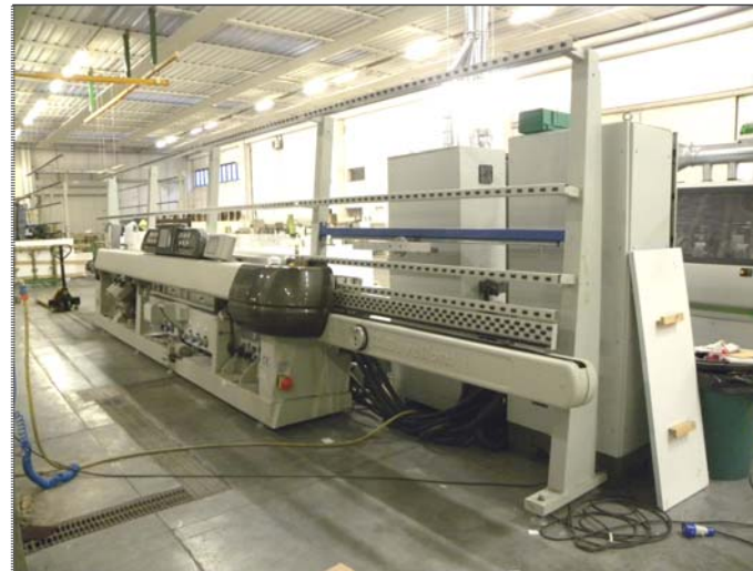
74) foratrice manuale, (senza marca) 76) lavorazione antine: molatrice rettilinea, Bavelloni / Glaston
