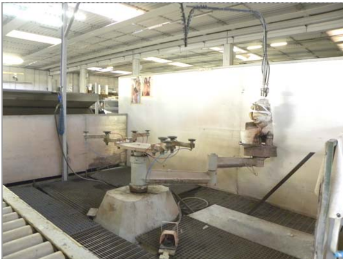
37) lavorazione CN: banco taglio ad acqua, Water-Jet
