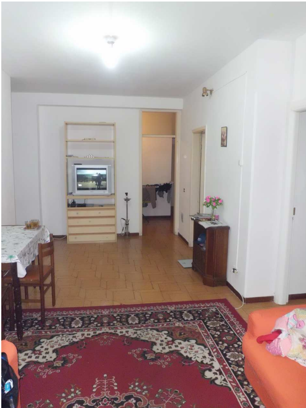
Foto n° 29 - 14/03/2019 - Comune di Maniago, foglio 20, part. 474, sub.67 – Stanza catastalmente identificata come soggiorno pranzo. In fondo a destra visibile la porta che da accesso alla cucina (riportata in planimetria catastale) e la porta che collega con il disimpegno (posizionata in maniera difforme alla planimetria catastale e alle planimetrie di progetto). In primo piano sulla destra visibile la porta che da accesso alla stanza da letto abusivamente ricavata costruendo una parete in cartongesso all'interno della stanza catastalmente identificata come soggiorno-pranzo.
