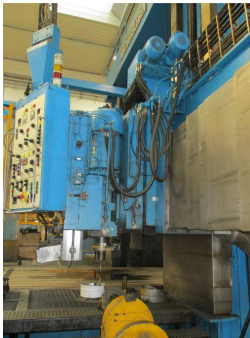
Rettificatrice a portale con vasca refrigerante munita di desolatore /ossigenatore testa tang./testa universale
