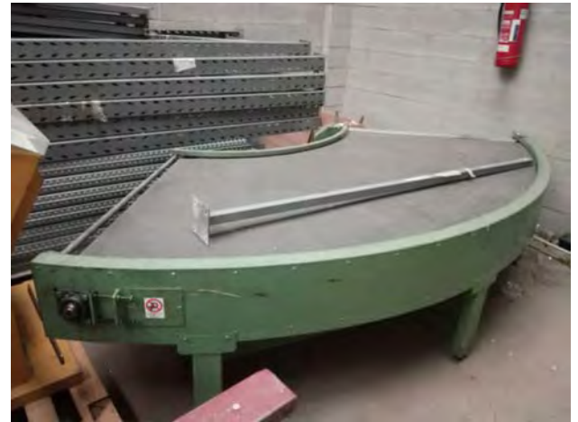
[78] Nastro trasportatore CURVA mt. 3 x 1.5LD.JPG
