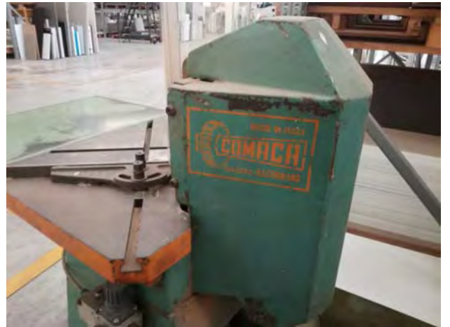
[94] Scantonatrice per schiene COMACA_LD.JPG
