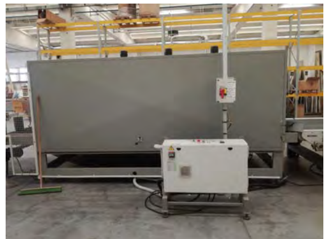
[64] Imballaggio termoretraibile Tunnel COMIL mod. TUNNEL SPACE SA...
