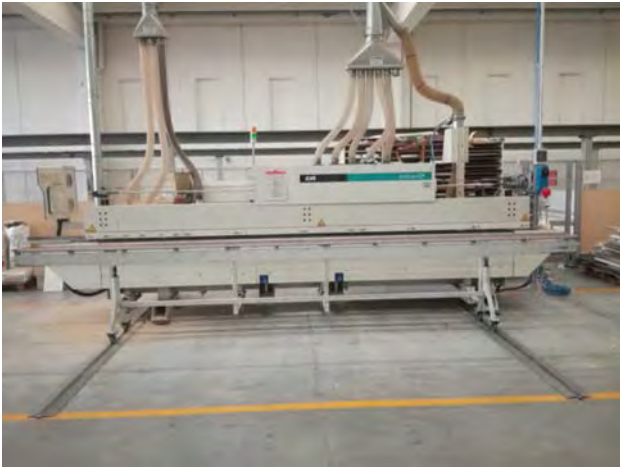
[17] Bordatrice monolaterale IDM mod. ACTIVA GP_R2LD.JPG
