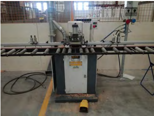
[51] Forainseritrice Cerniere QUADRIO mod. RQ 12LD.JPG
