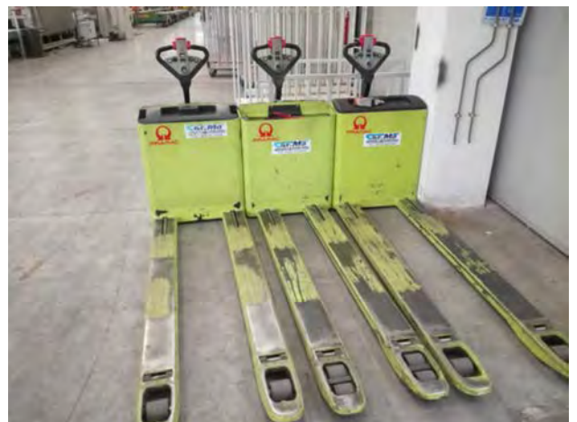
[32] Carrello Transpallet elettrico mod. QX20LD.JPG
