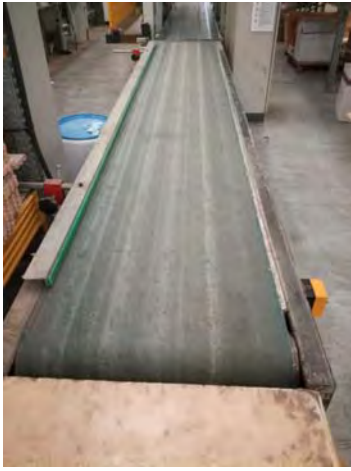
[81] Nastro trasportatore mt. 4 x 0,6LD.JPG
