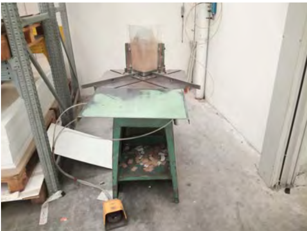
[95] Scantonatrice per schiene COMACALD.JPG
