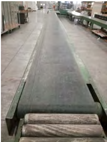
[83] Nastro trasportatore mt. 13 x 0.75LD.JPG
