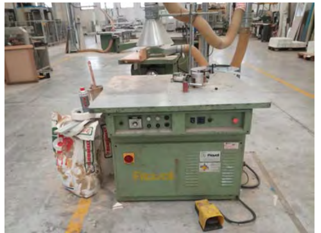
[22] Bordatrice per curvi FRAVOL mod. A16_S2LD.JPG
