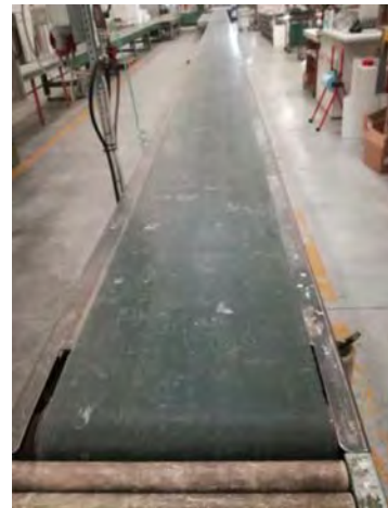
[84] Nastro trasportatore mt. 18x 0.75LD.JPG
