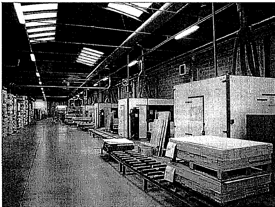
Area foratura automatica: foratrici/inseritrici spine - Osma
